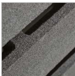
EPP-Polypropylen hat effektive Dämmeigenschaften
